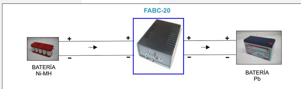
**BOMBA DE CARGA FABC-20** permite transferir la carga de una batería a otra aunque sean iguales o de diferente tensión o tecnología.
